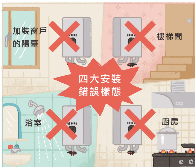
圖 2 錯誤的安裝方式
