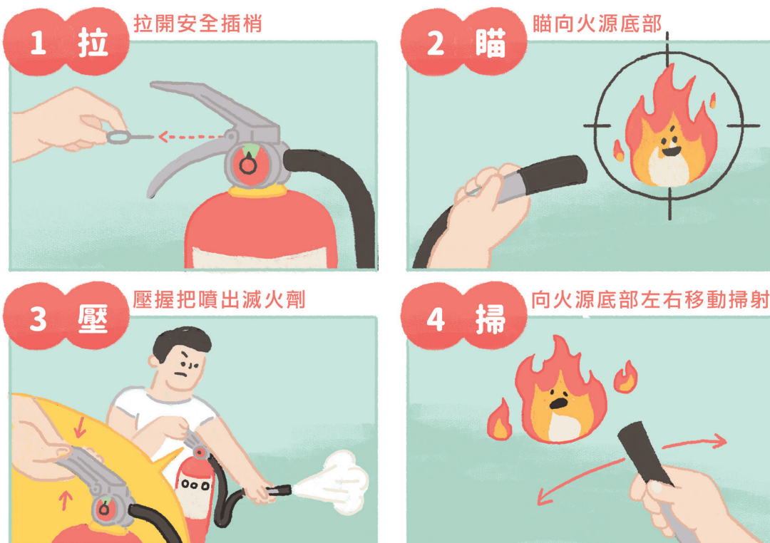
圖 16 滅火器操作方式
