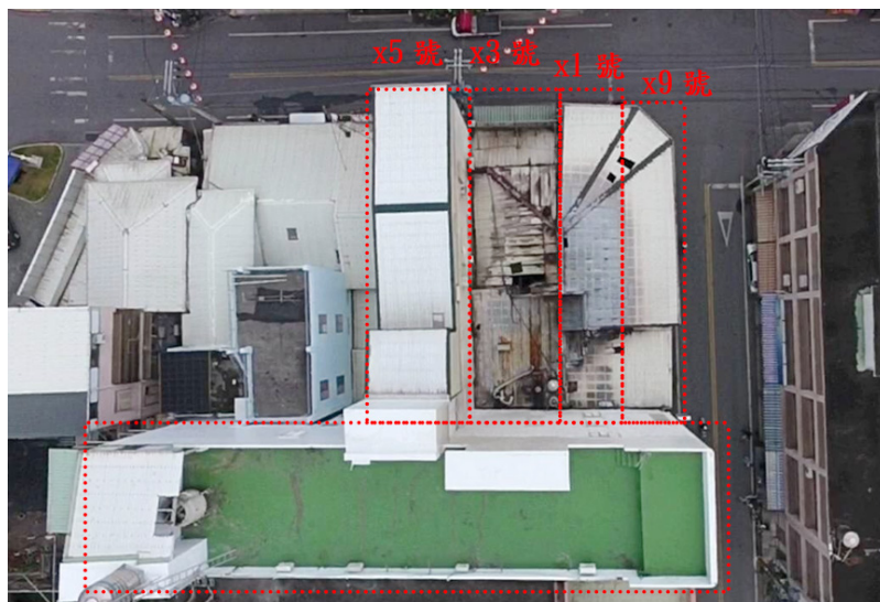
圖二、建築物外觀燒損情形
