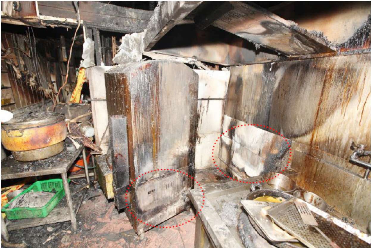
圖四、牆面燃燒痕跡與蒸爐內爐火設置位置
