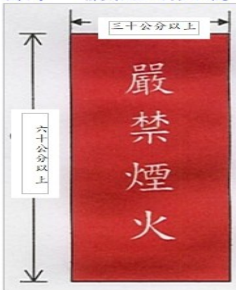
圖例一、嚴禁煙火標示板
